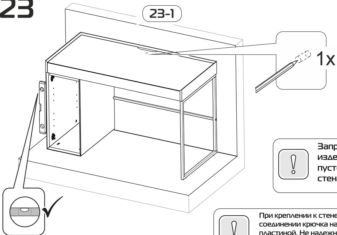
При креплении к стене, убедитесь в надежном соединении крючка навески с монтажной пластиной. Не надежное соединение грозит падение изделия во время эксплуатации
